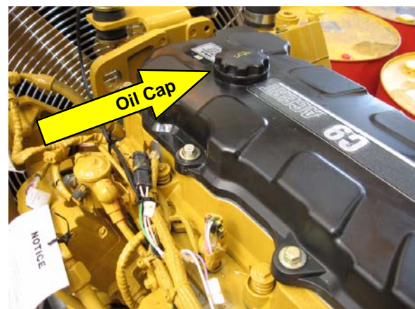
2: Refill if necessary. (CN6125)
